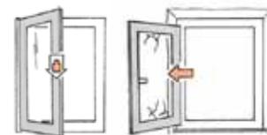
Der Fensterflügel darf nicht mit zusätzlichem Gewicht belastet werden. Nicht an die Mauerleibung schlagen oder drücken.
