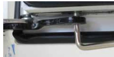
Anpressdruckverstellung Torx 15
