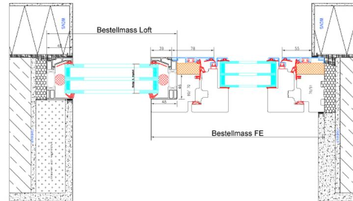
Einbaudetail Hebe-Schiebe mit LOFT:
